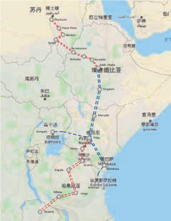
图 4.14 东部非洲南北输电走廊工程示意图
